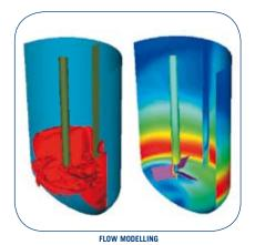
SPEED PROFILE ANALYSIS AROUND MOVING PARTS
